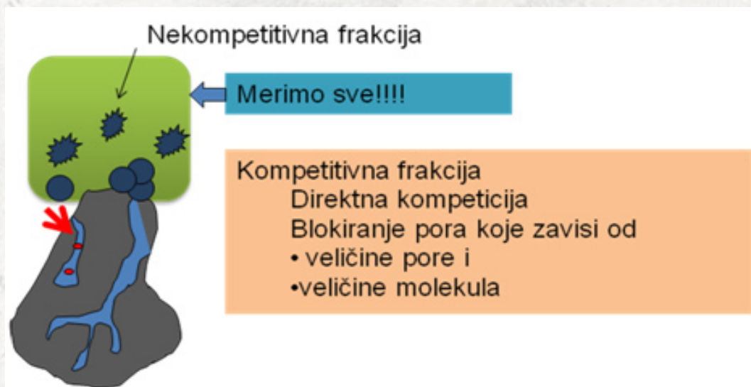
Slika 2. Adsorpcija prirodne organske materije na čestici i u porama čestice aktivnog uglja utiče na njegovu efikasnost u uklanjanju sintetskih organskih hemikalija. (Crtež čestice adaptiran iz prezentacije Hobby i sar., 2011)
